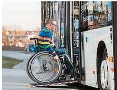
Nur niederflurgerechte Bushaltestellen werden zum Ein- und Ausstieg empfohlen, da ansonsten die Rampe aus sicherheitstechnischen Gründen nicht ausgeklappt werden kann.
