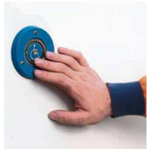
Der Anforderungsknopf ist an der 2. Bustüre angebracht. Er wird gedrückt, wenn die Rampe ausgeklappt werden soll.
